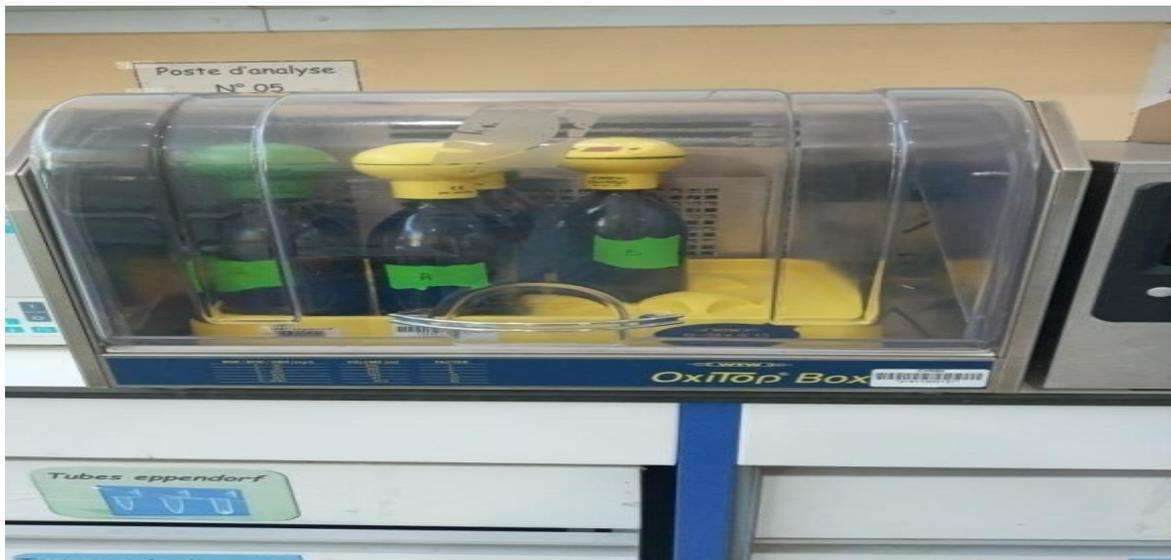
**Figure III.13: incubateur pour Dosage de la DBO5**
