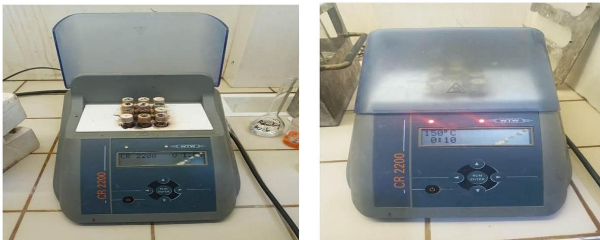
Figure III.14: Bloc Chauffant pour dosage de le DCO.
