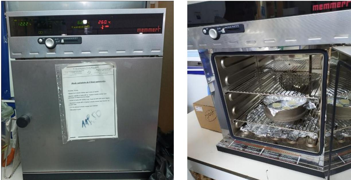
Figure III.10 : Séchage de filtre dans l'étuve.
